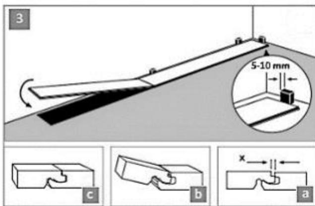
3. Уложить первый ряд, оставив зазор у стены 5 мм, ровность которого обеспечивается клиньями.
