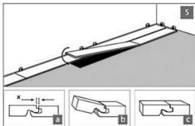
5. Второй и последующие ряды укладываются соединением с предыдущим рядом по длинной стороне и соединением в торцах. Смотрите рекомендации производителя по защелкиванию замков. Обычно шип по длинной стороне располагают поверх паза плитки предыдущего ряда, приподнимают на 15-30 градусов обе планки и двигают последнюю доску до защелкивания замка по длинной стороне.
